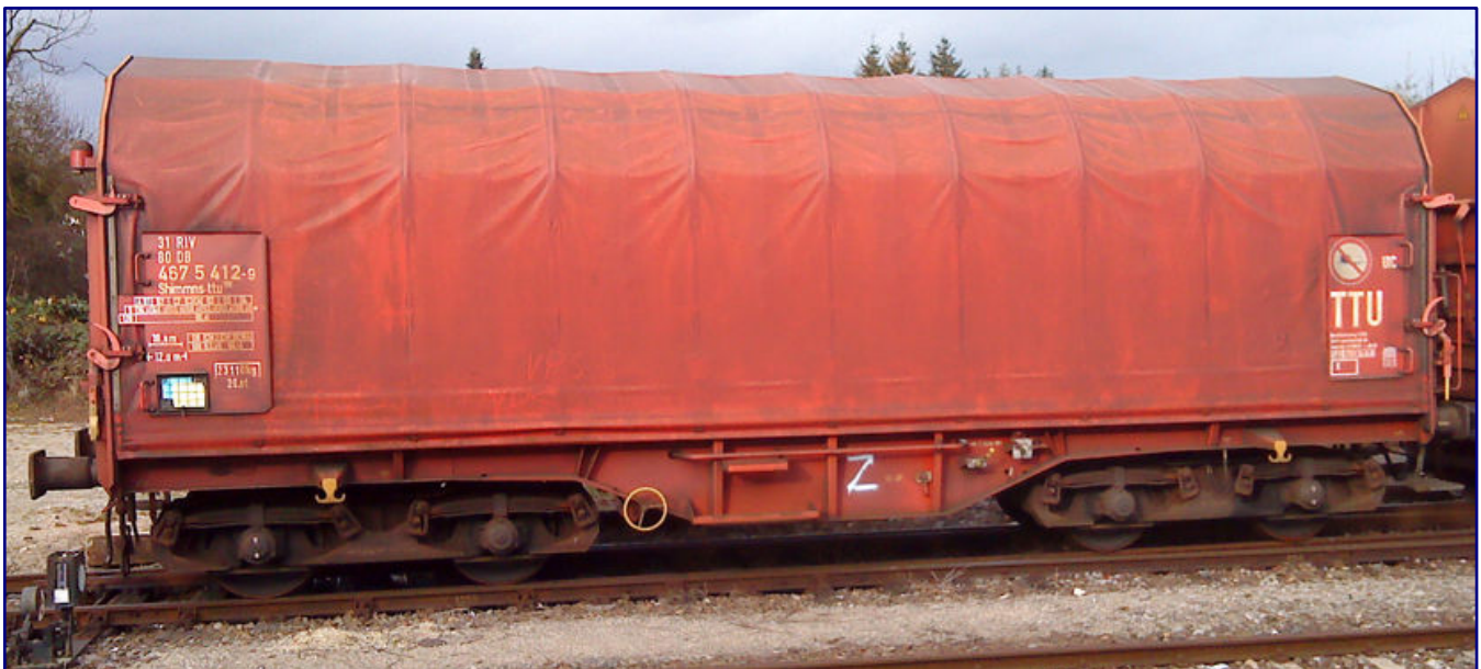
Der Shimmns-ttu 722 ist an seinem fast vollständig sichtbaren Langträger wie auch der Form des Fischbauchs (vgl. Foto auf Seite 5 oben) als Umbauwagen zu erkennen. Foto: Ketamin (CC-BY-SA-3.0)
