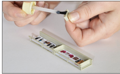
2. Trennwände einkleben zur Lichtabschottung zwischen Fenstern und Türen sowie als Endabschluss. Glue the dividing walls to cover the light between windows and doors as well as for final end.
