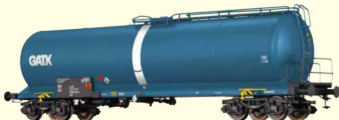
Neubaukesselwagen 4-achsig Zas GATX Betriebs-Nr. 33 80 7956 518-4
