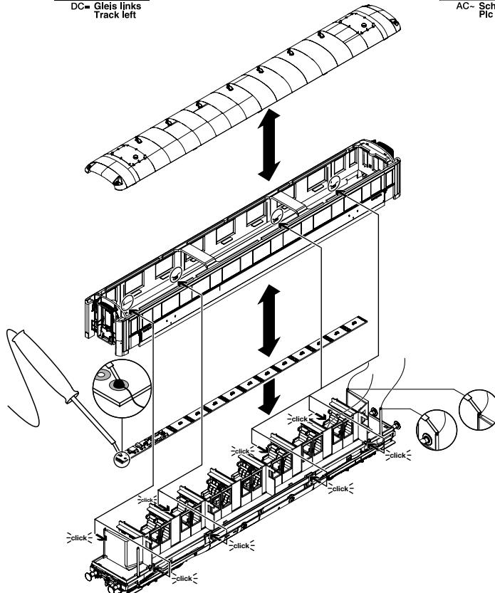
Montage Wechselstromschleifer, Bestell-Nr. 2222
