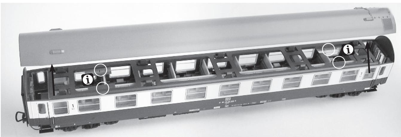
**(DE) Montage Radschleifer Y-Salonwagen • (GB) Installation of wheel pick-up shoes • (FR) Montage des frotteurs d'essieux • (CZ) Montáž kartáčů kol • (PL) Montaż ślizgaczy**
