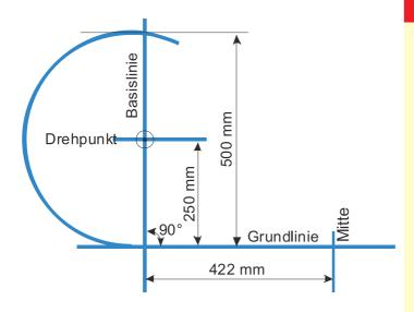
Sie brauchen eine freie Fläche von 140 cm x 60 cm. Zeichnen Sie die Grundlinie auf. Von der Mitte aus zeichnen Sie 422 mm nach links im rechten Winkel dazu die Basislinie für den Kreisbogen. Messen Sie von der Grundlinie aus 250 mm auf der Basislinie ab. Diese Markierung ergibt den Drehpunkt für den Kreisbogen. Ziehen Sie einen Halbkreis von 250 mm. Der Schnittpunkt auf der Basislinie ergibt einen Abstand zur Grundlinie von 500 mm.
