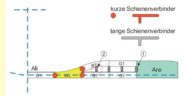
Ausweiche links (Ali): Legen Sie alle Grundplatten wie im Beipackzettel dargestellt auf die Grundlinie. Stecken Sie in die Weiche die kurzen Schienenverbinder, den kurzen Teil gegen die Weiche. Stecken Sie die langen Schienenverbinder in die übrigen Grundplatten und schieben Sie alle Elemente zusammen.
