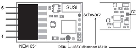
Entfernen Sie den Brückenstecker aus der NEM 651 Schnittstelle Ihres Fahrzeuges. An gleicher Stelle stecken Sie den Lokdecoder vorsichtig in die Schnittstellenbuchse ein. Bitte die Kodierung über PIN 1 (Licht hinten, gelb) beachten.
