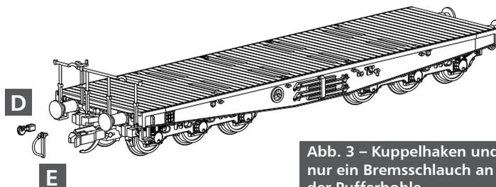
Abb. 3 – Kuppelhaken und nur ein Bremsschlauch an der Pufferbohle
