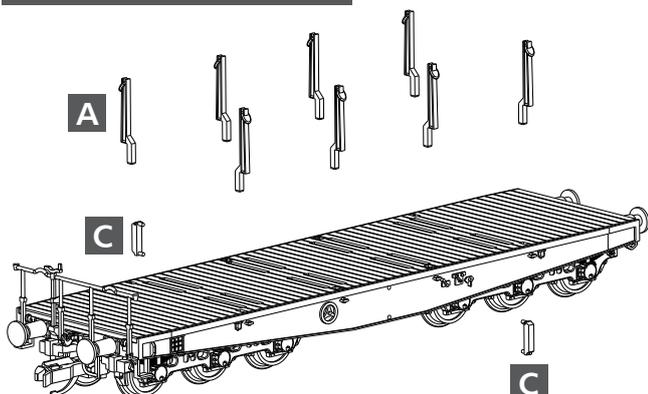
Abb. 2 – Ohne montierte Rungen, Rungen stecken im seitlichen Rungenhalter (ein ansteckbares Teil im Modell)
