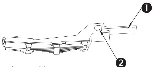
**2** (DE) Sitz auf Führungsstift überprüfen! Federpaket muss sich leicht bewegen lassen und bei Geradeausfahrt in seine Ausgangslage zurückfedern.
