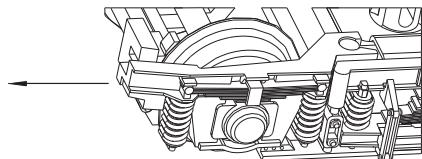
**1** (DE) Wiedermontage: Federzunge in Freiraum zwischen Achslagerbrücke (Blechteil) und Drehgestellblende einführen.
