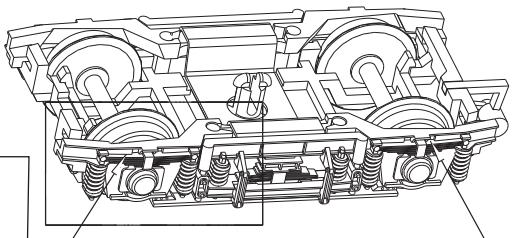
(DE) Bei Kurvenradien unter 310 mm müssen diese Federpakete entfernt werden.
