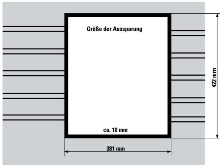
Soll auch bei Verwendung des K-Gleises die Schienenoberkante eben liegen, muss die Schiebebühne in der Anlagengrundplatte versenkt werden. Die kleinen Füße an den Gleisstücken 2291 sind hierfür mit einem Messer oder der Laubsäge abzuschneiden.
