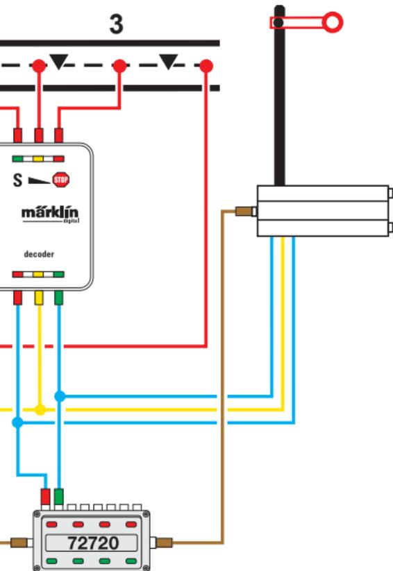
H0: Digitale Magnetartikelsteuerung/Lichtsignal mit Antrieb
