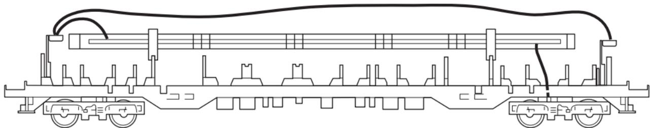
Anschluss der Innenbeleuchtung 7330 an Wagen mit Schleifer.
