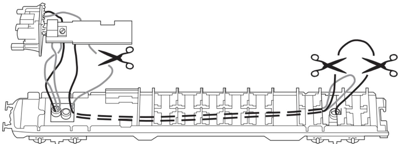
Anschluss der Innenbeleuchtung 7330 in Steuerwagen
