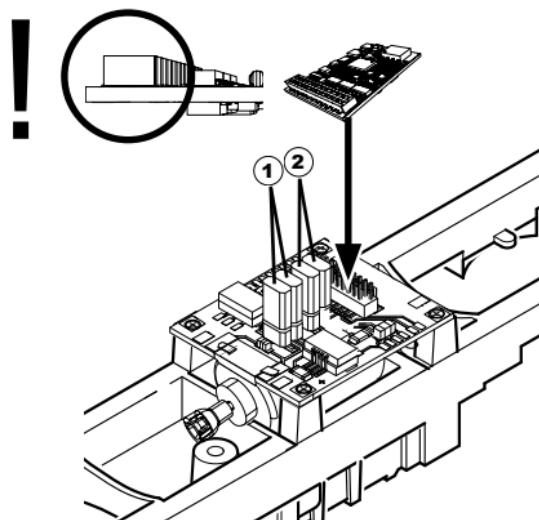
① Bygeln (jumpern) möjliggör ändringar av lokets körriktning. Detta erfordras t.ex. när strålkastare och körriktning inte överensstämmer.
