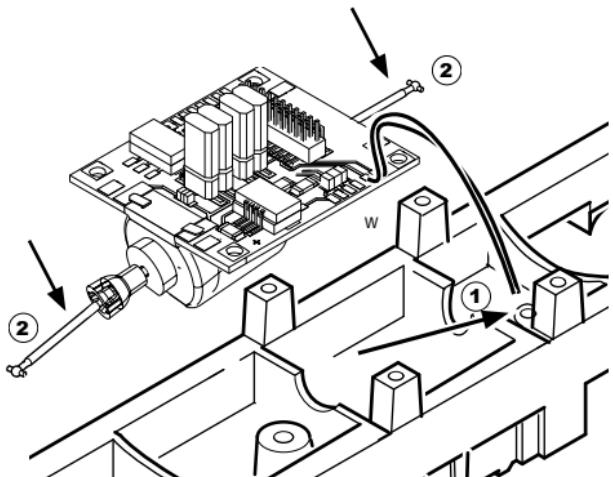
Print vastschroeven, draden er aan solderen en de flexband weer in de stekkerbus steken
