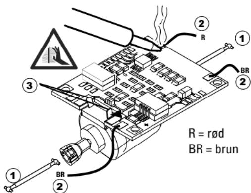
Løsn motoren fra printet.
