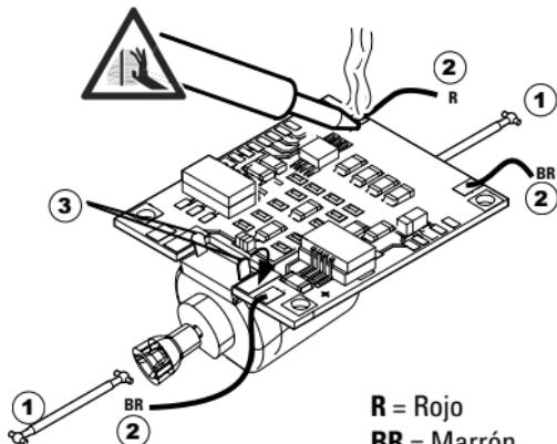
Desacoplar el motor de la tarjeta de circuito impreso. Para eliminar la tarjeta de circuito impreso, véase consejo en página 26.
