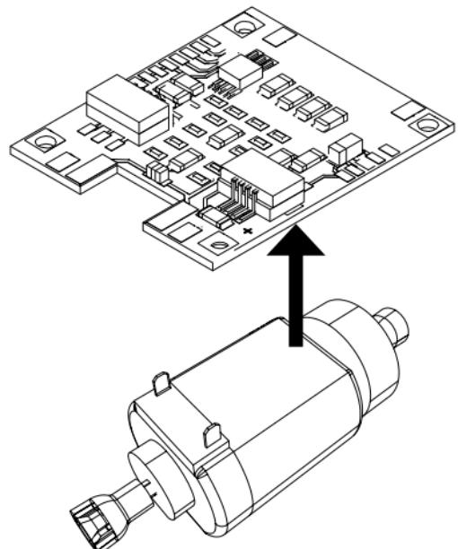
De nieuwe print op de motor leggen, de soldeerlippen **①** weer voorzichtig terugbuigen. De motor d.m.v. de beide soldeerlippen weer aan de print vast solderen.
