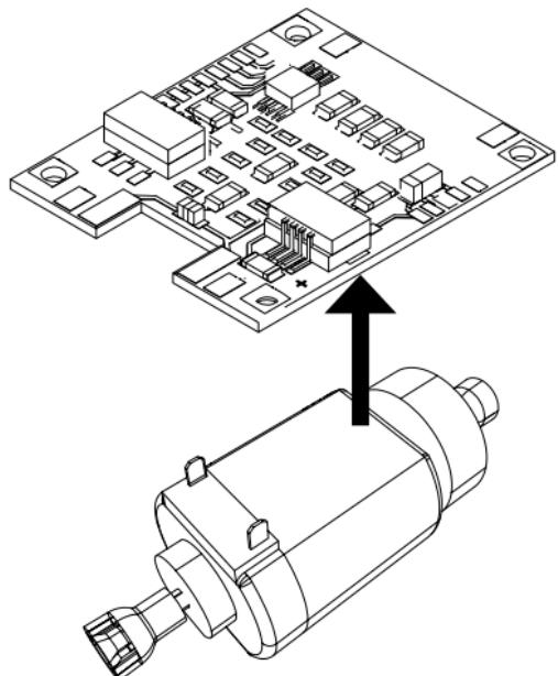
Die neue Platine auf den Motor legen, die Lötfahnen wieder vorsichtig zurückbiegen. Motor mit beiden Lötfahnen an die neue Platine anlöten.
