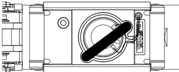
Stick i dekodern, kontrollera att den hamnar rätt. Ställ nu loket, utan kåpa/kaross, på programmeringsspåret och prova att loket fungerar. Går loket problemfritt så kan lokkåpan monteras.
