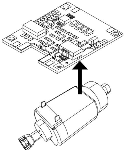
Collocare il nuovo circuito stampato sopra il motore, ripiegare nuovamente con cautela le alette di saldatura. Saldare il motore al nuovo circuito stampato con le due alette di saldatura. ①
