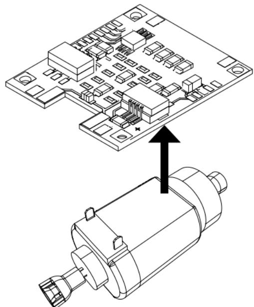
Lägg den nya dekoderplattan ovanpå motorn, böj försiktigt tillbaka lödpunkterna. Motorn förbinds med bågge lödpunkterna på den nya dekoderplattan.
