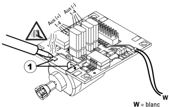
Faites passer les deux câbles blancs ① par le châssis de la locomotive.
