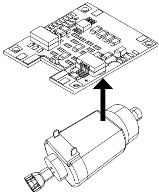
Colocar la nueva tarjeta de circuito impreso sobre el motor y doblar de nuevo hacia atrás con cuidado las ferrulas soldables. Soldar el motor con ambas ferrulas soldables a la nueva tarjeta de circuito impreso.
