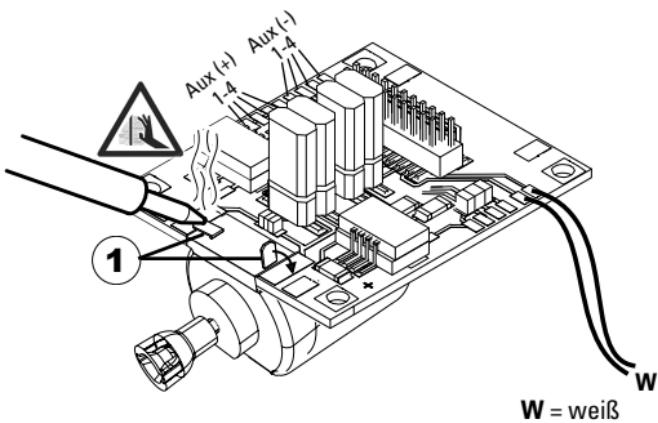
Die zwei weißen Kabel ① durch den Lokrahmen führen.
