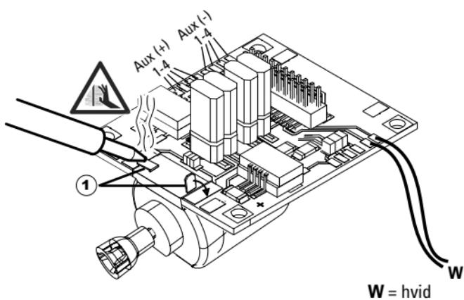
Før de to hvide kabler ① gennem lokomotivets chassis.
