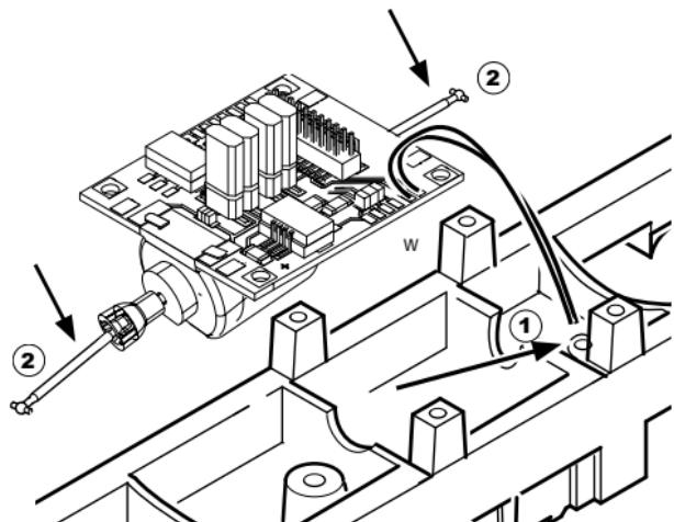
Platine festschrauben, Kabel anlöten und Flexband wieder einstecken
