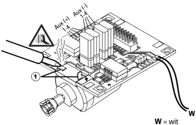
De beide draden **①** door het locomotieframe voeren. De beide cardanassen **②** in de opname steken en weer monteren.
