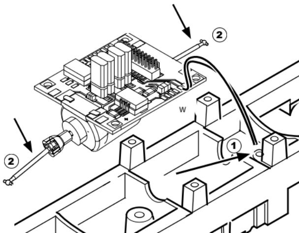
Skruta fast kortet, löt fast kortets kablar och sätt tillbaka flexbandet
