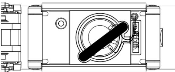
Innestare il Decoder, si presti attenzione al corretto montaggio. Sottoporre il modello ancora senza mantello ad una verifica sul binario di programmazione. Quando il Decoder funziona senza inconvenienti, il mantello può venire rimontato.
