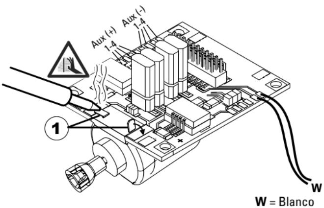
Pasar los dos cables ① blancos a través del bastidor de la locomotora.
