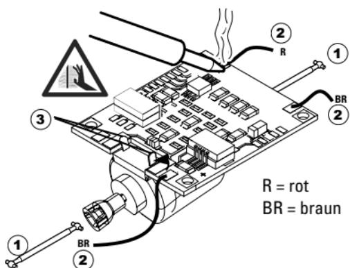
Motor von der Platine lösen.
