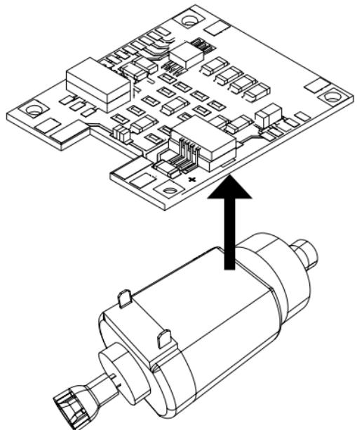
Poser la nouvelle platine sur le moteur, recourber de nouveau prudemment les languettes de soudage. Souder le moteur les deux languettes de soudage à la nouvelle platine.
