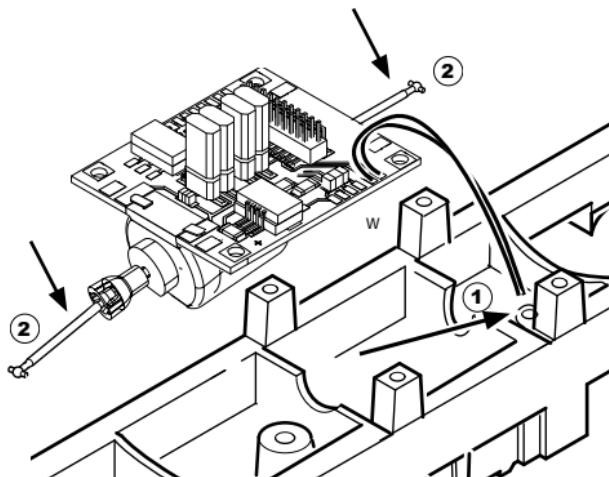
Visser fermement la platine, souder le câble et rebrancher la bande flexible
