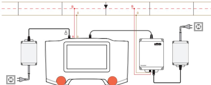
Si vous souhaitez utiliser d'autre boosters 60175 avec la Central station, vous pouvez raccorder le terminal 60125 à la Central Station et relier jusqu'à quatre boosters à chaque terminal.
