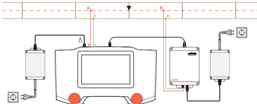
Qualora Voi desideriate mettere in funzione degli ulteriori Booster 60175 con la Central Station, potete allora collegare il Terminal 60125 con la Central Station e connettere a ciascun Terminal sino a quattro Booster.
