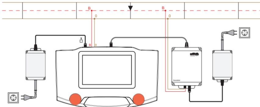
Hvis du vil anvende yderligere boostere med Central Station, kan du forbinde terminal 60125 med Central Station og tilslutte op til fire boostere til hver terminal.
