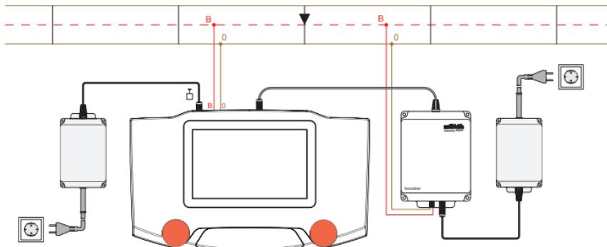
Si desea utilizar boosters 60175 adicionales junto con la Central Station, puede interconectar el terminal 60125 a la Central Station y conectar hasta cuatro boosters por cada terminal.
