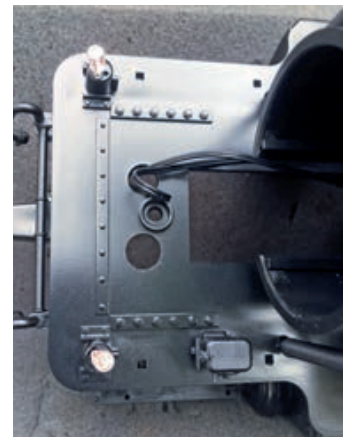
Fahrgestellrahmen vorne, die zweite Bohrung ist bereits eingebracht.
