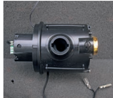
Vorderes Kesselteil von oben, Verdampfer eingeschoben.
