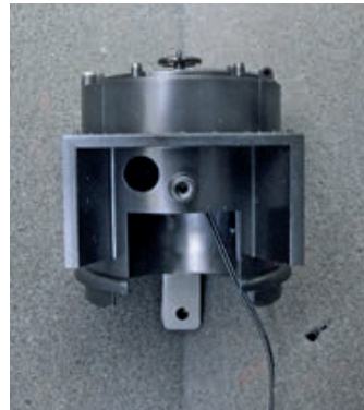
Vorderes Kesselteil von unten mit ursprünglich vorhandener Bohrung.
