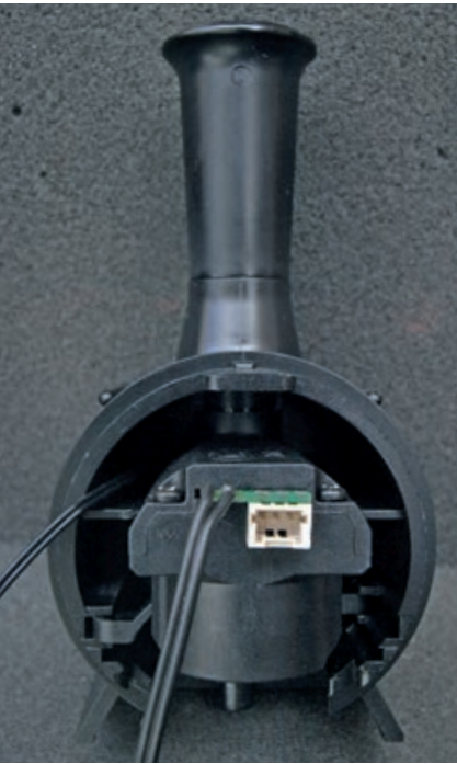
Vorderes Kesselteil von hinten, der Verdampfer ist eingeschoben und der Schlot montiert.
