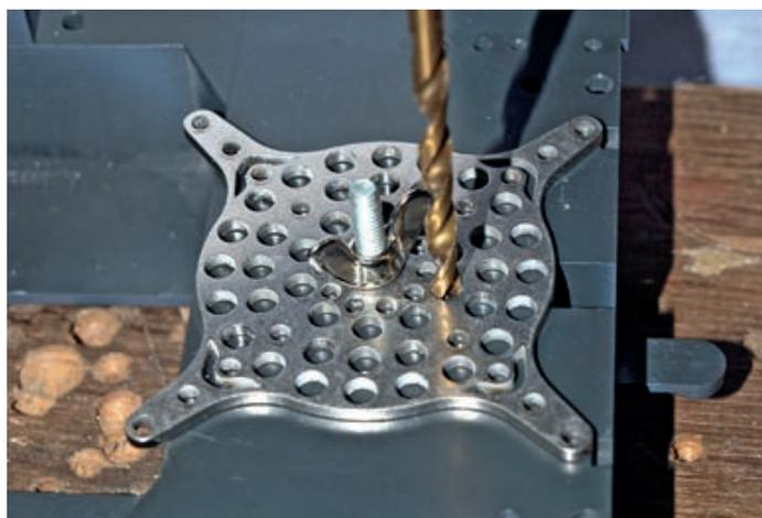
Fertigung der Schallaustrittsbohrungen mit einem 4-mm-Bohrer.
