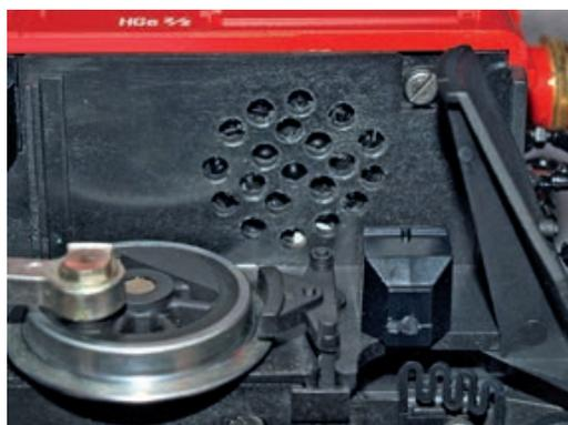
So muss das nicht mehr aussehen: „Freihändig“ gebohrte Löcher im Boden einer FO-Zahnradlok (links). Trotz sorgfältigem Anreißen und Bohren ist das Ergebnis nicht ganz gleichmäßig. Die mit der Schablone gebohrten Löcher im Boden des Hermann3D Schneepflugs (rechts) zeigen ein sehr sauberes Bohrmuster.
