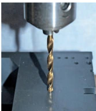
Zuerst wird eine Zentrierbohrung eingebracht, damit die Bohrschablone fixiert werden kann.
