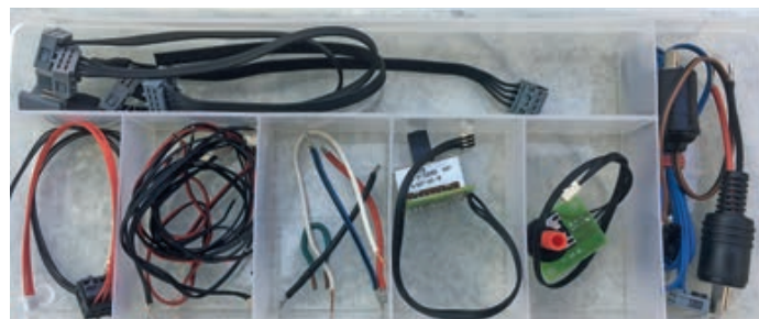
Griffbereit in einer Kleinteilebox: Diverse Kabel, Poti und Motorschalter
