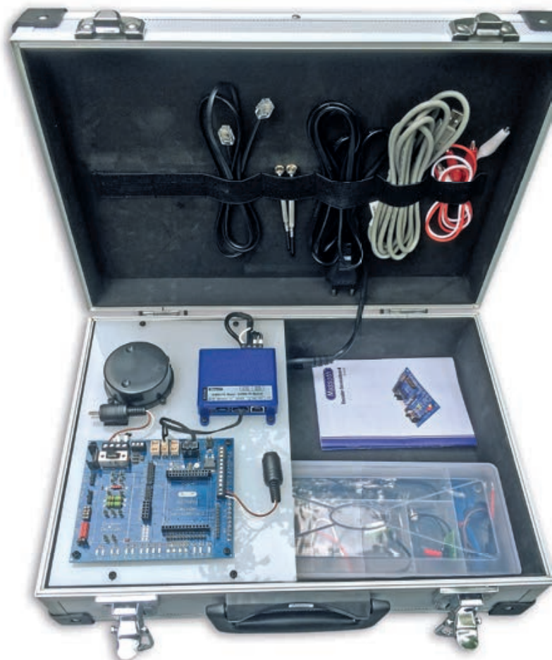
Bewährt sich: Festeinbau des Serviceboards im Koffer mit Steckern fürs Testbord in der Klarsichtbox und den PC-Kabeln im Kofferdeckel
