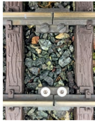
Massoth-Verbinder mit LGB-Messinggleis, oben Messingschrauben, unter Edelstahl-Inbusschrauben.
