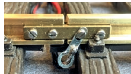
Madlerer Verbinder mit Strom-einspeisung, Seitenansicht.
