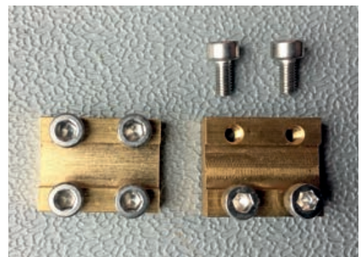
Meyer: Vier Inbussschrauben sichern die beiden Schienenprofile, wobei die Schienenfüße in eine Profilmulde gelegt werden; bequem von oben zu verschrauben.
