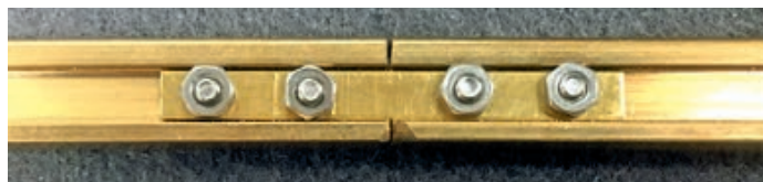
Thiel-Laschenverbinder, hier auf Gleisaußen-seite mit Profilen verschraubt. Die Muttern fixieren sich zwischen Schienenfuß und -Kopf nahezu selbst.
