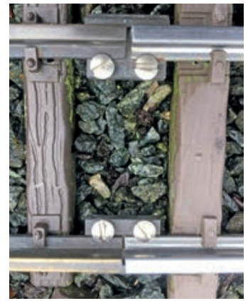
Massoth-Verbinder mit Edelstahlschrauben mit LGB-Messinggleis (links) und Revalda Edelstahlgleis.
