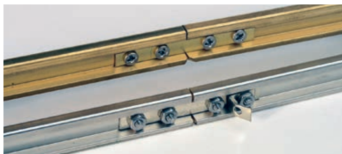
So wurden früher auch beim Vorbild Schienenstöße verschraubt, bevor die Schweißtechnik Einzug hielt: Schienenverbinder von Thiel innen und außen
