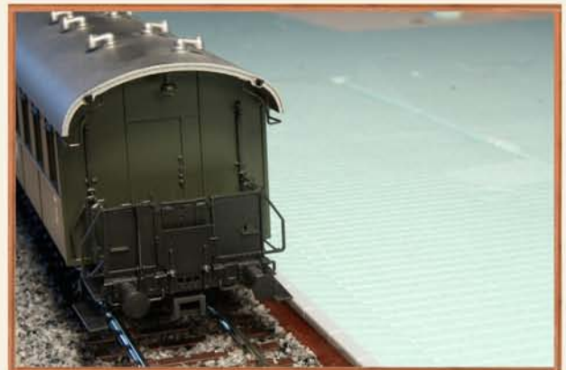
VI Zwischenraum mit einer ca. 6 mm Hartschaumplatte füllen.
