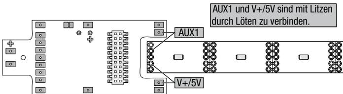
AUX1 und V+/5V sind mit Litzen durch Lötten zu verbinden.
