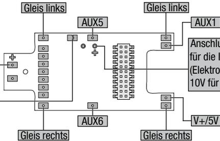
Anschluß eines Pufferkondensators für die Innenbeleuchtung (Elektrolytkondensator 220µF; 10V für DC und AC)
