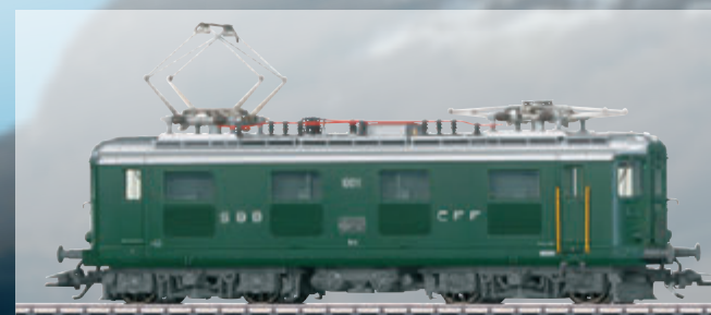
Die linke Lokseite mit den markanten Lüftergittern unterhalb der Gangfenster
