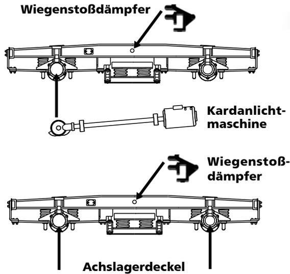
Die Bahnpostwagen sind an beiden Drehgestellen mit einer Kardanlichtmaschine ausgerüstet. Die Lichtmaschinen werden auf der gegenüber dem Toilettenabteil befindlichen Wagenseite am Drehgestell befestigt.
